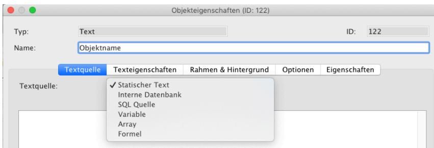
Folgende Optionen stehen für die Textquelle, die gedruckt wird, zur Verfügung:
