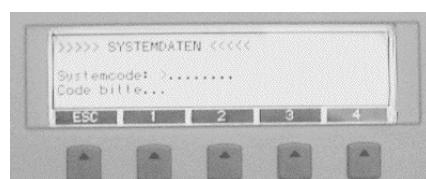
Das Terminal befindet sich im Konfigurationsmodus.
